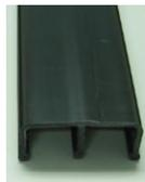
マックスロックはコンクリート打設時に構造物と一体化させ、遮水シートと押し溶接で取り付けることができる部材です。従来遮水シートとコンクリート構造物をフラットバーとアンカーボルトで取り付けていた工法に比べ、連続性、止水性、耐久性を大幅に向上させることができます。
